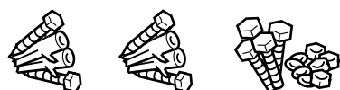
Vis de fixation de la plaque de base et de l'angle au mur
